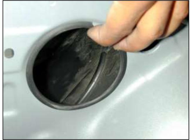
g. Attach the rubber edge trim. Cut away any excess.
