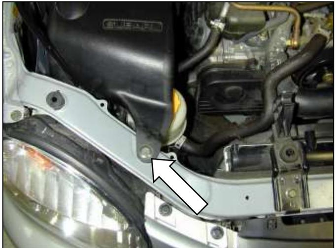
b. Loosen and remove bolt.
